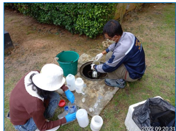
รูปที่ 3.2 แสดงการเก็บตัวอย่างน้ำเข้าระบบบำบัด และน้ำผ่านระบบบำบัด “อาคารส่วนกลาง”
