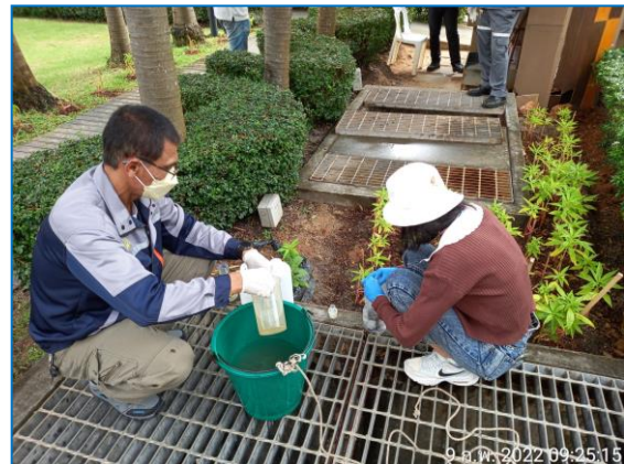
รูปที่ 3.3 แสดงการเก็บตัวอย่างน้ำบ่อกักน้ำสุดท้ายก่อนระบายออกนอกโครงการ
