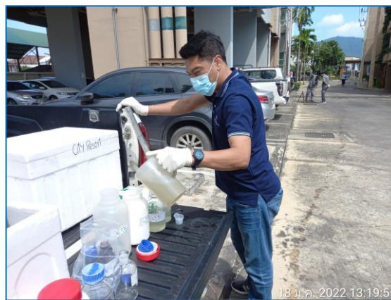
รูปที่ 3.1 แสดงการเก็บตัวอย่างน้ำเข้าระบบบำบัด และน้ำผ่านระบบบำบัด “อาคารบ้านพัก”
