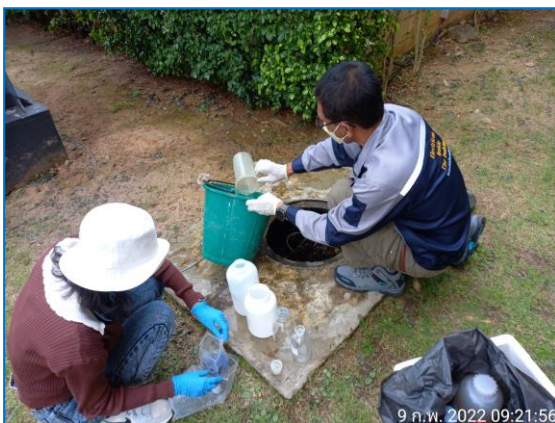
รูปที่ 3.2 แสดงการเก็บตัวอย่างน้ำเข้าระบบบำบัด และน้ำผ่านระบบบำบัด “อาคารส่วนกลาง”
